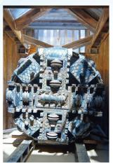
竹園道首階段頂管工程順利完成從竹園道(東行)近鵬程苑至 竹園道(西行)近竹園南邨的第一條頂管隧道工程於2025年6 月順利完成。此階段涉及挖掘一條內徑2.5米、長度約140米 的頂管隧道。通過採用無坑挖掘頂管技術,承建商可以在無需 影響竹園道與穎竹街十字路口交界的交通情況下,在頂管隧 道完成後,於隧道內進行水管敷設工程,從而減低對道路使用 者的影響。
